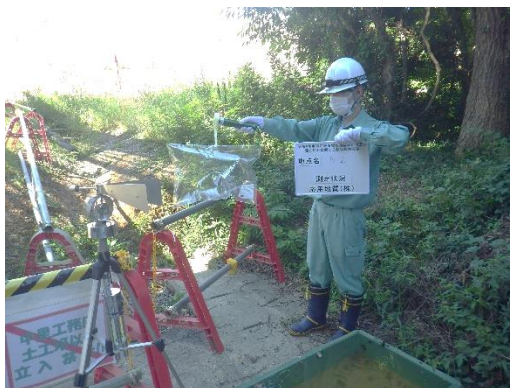
写真 4.10 河川水水質の測定状況
