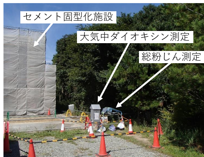
写真 4.4 ハイボリウムエアサンプラー
