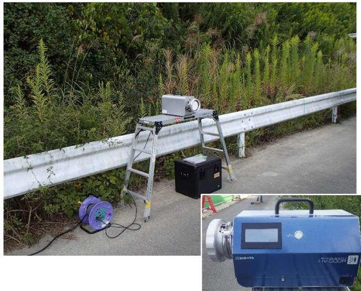
写真 4.2 ハイポリウムエアサンプラー
