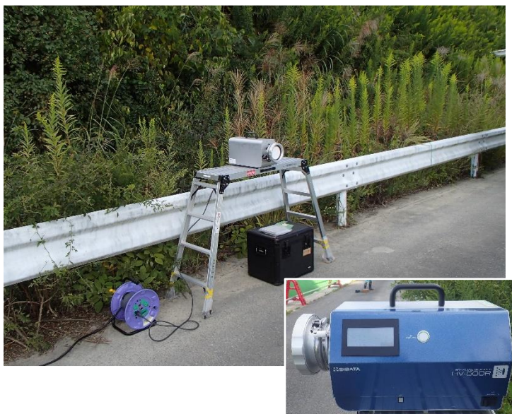
写真 4.3 ハイボリウムエアサンプラー
