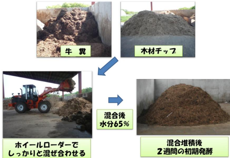
発酵床の製造工程
